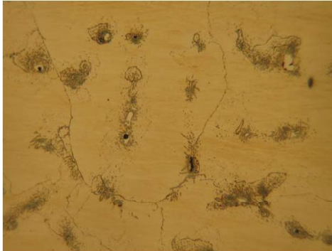
Figure 21 : Coupe Micrographique d'acier 1 avant traitement thermique, à grossissement 200X.
