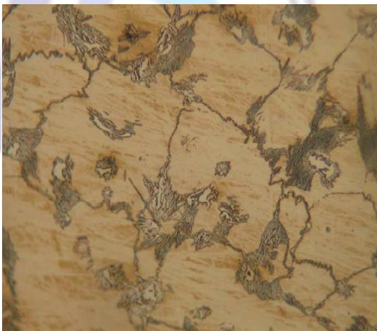
Figure 14. Coupe Micrographique d'acier 1 avant traitement thermique, grossissement 500X.
