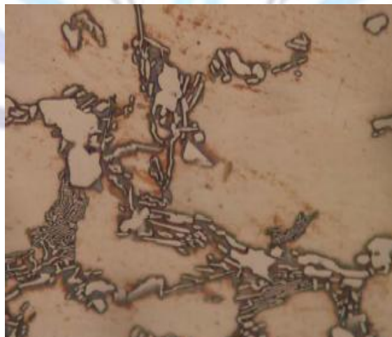
Figure 20 : Coupe Micrographique du cœur de l'acier 1 avant traitement thermique, à grossissement 1000X
