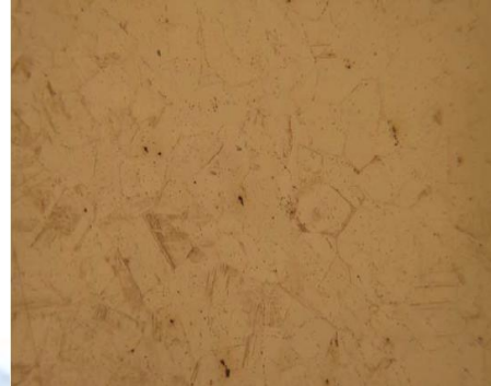
Figure 22 : Coupe Micrographique d'acier après traitement thermique 3, à grossissement 200X.
