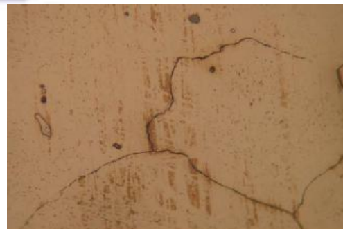
Figure 26 : Coupe Micrographique d'acier 2 après traitement mécanique, grossissement 500X.
